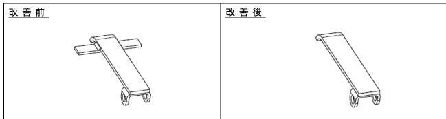
大型トラクタの連結装置において、誤連結防止部品(ロックガード)の形状が不適切なため、トラクタとトレーラの高さがあっていない状態で連結操作をおこなうと、ロックガードが正しく作動せず誤連結状態であっても多重表示モニターに正常連結状態を示すカプラ—ロックインジケーター(緑色)が表示されることがある。そのため、走行中にトレーラが分離するおそれがある。
