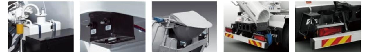
液量計付オイルリザーブ      水ポンプスイッチ&作業灯スイッチ      電動ホッパーカバー      残水受け      ペール缶ホルダー
