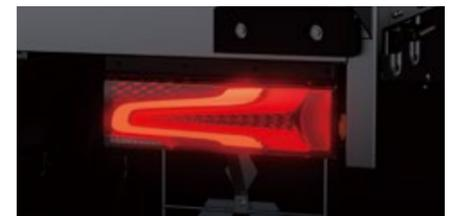
\*ストップランプ、テールランプ、ターン(方向指示)ランプ、バックランプ、リヤフォグランプを一体化\*写真のランプはTYPE Lです。ミキサはTYPE Sの設定となります。
