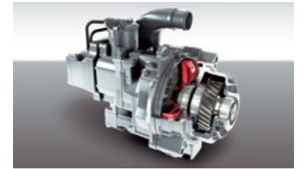
流体式リターダー (FV-Rの6R30(T4/T5)エンジン車、 FP-Rの6R30(T2/T3:低床仕様車を除く) および6R20(T3)にメーカーオプション)
